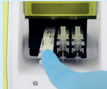
Testkassette mit Pipettenspitze in Kassettenhalter schieben.
