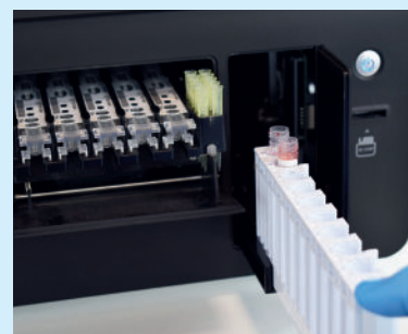
Probenhalterung einsetzen und Messung starten.
