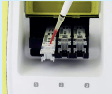
Patientenprobe in eingesetzte Testkassette pipettieren.
